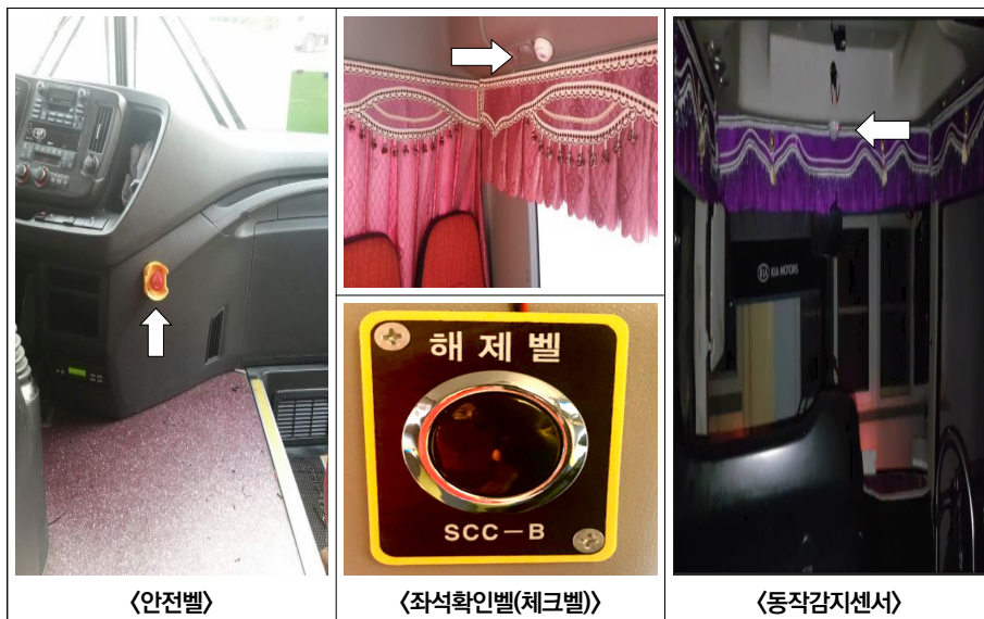
〔그림 4〕 어린이통학버스 하차확인장치 설치 사례
