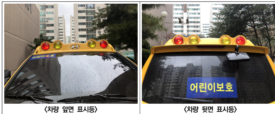
[그림 1] 어린이통학차량 교통 표시등 설치 사례
