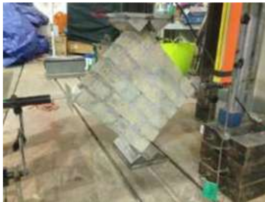
[해그림 6-4] 사인장 전단시험 (ASTM E519)
