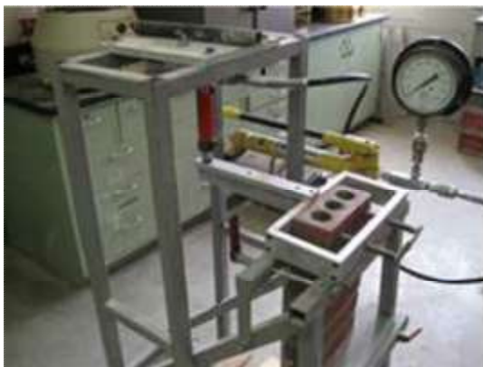
[해그림 6-2] 휨인장강도-Bond wrench test (ASTM C1072)
