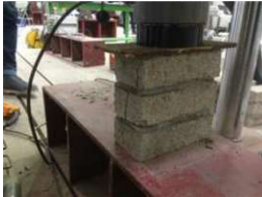
[해그림 6-1] 압축강도 및 탄성계수 (ASTM C1314)
