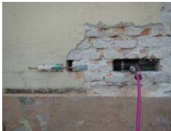
[해그림 6-5] 모르타르 수평줄눈 전단강도 현장시험 (ASTM C1531)
