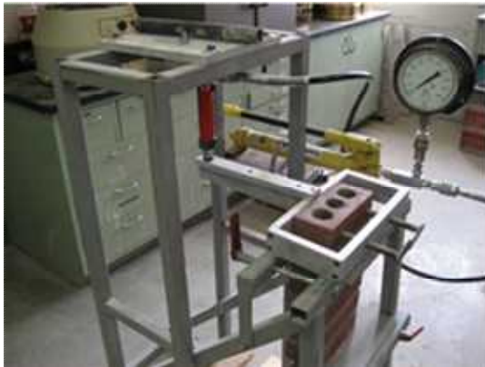
[해그림 6-2] 휨인장강도-Bond wrench test (ASTM C1072)
