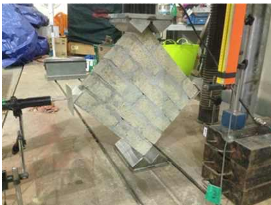
[해그림 6-4] 사인장 전단 시험 (ASTM E519)
