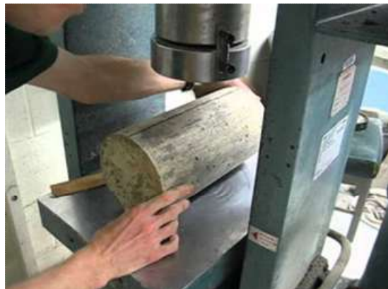
[해그림 6-5] 쪼갬인장강도 시험 (ASTM C496)
