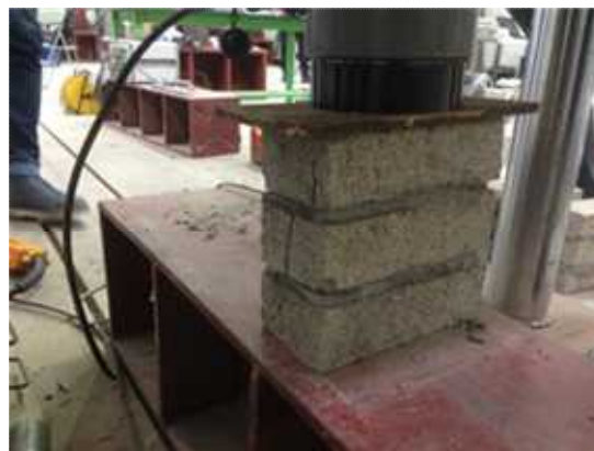
[해그림 6-1] 압축강도 및 탄성계수 (ASTM C1314)
