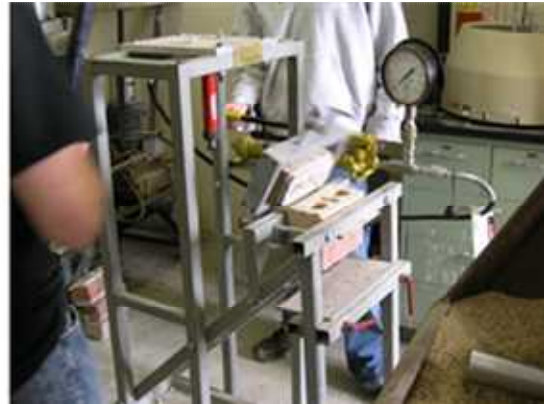
[해그림 6-2] 휨인장강도-Bond wrench test (ASTM C1072)
